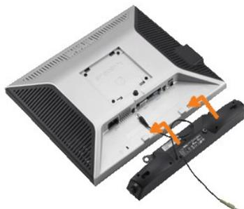
1. Sur l'arrière du moniteur, fixez la Soundbar en alignant les deux orifices avec les deux languettes sur le bas à l'arrière du moniteur.
