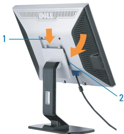
1. Ajustez la rainure sur le moniteur sur les deux loquets sur la base.
